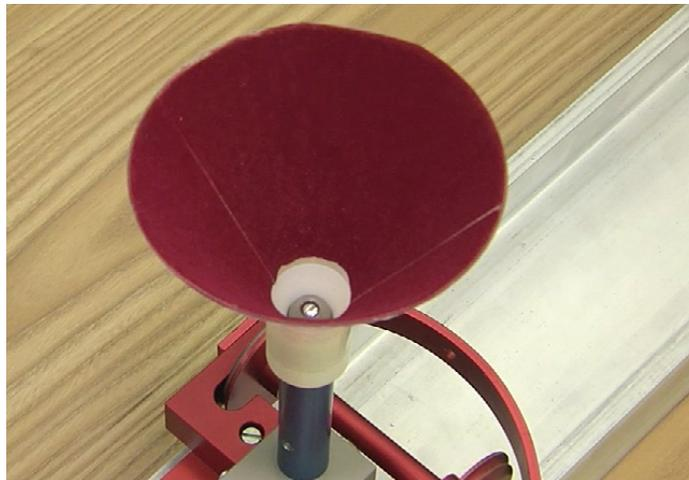
Abbildung 1: Auffangtrichter mit Kugel; Abschussfeder ist gespannt
