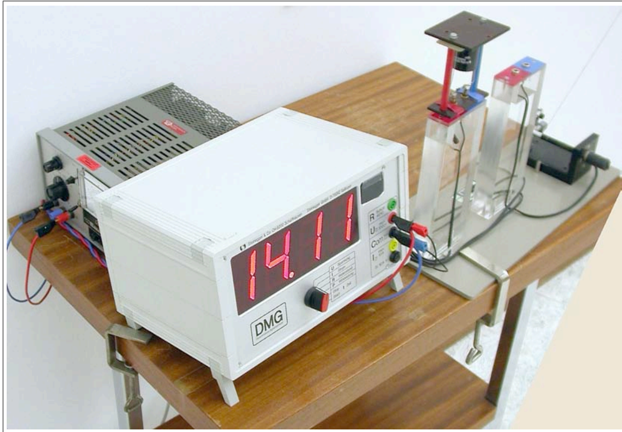
Abbildung 2: Kondensator mit den beiden Steckplätzen, Voltmeter und Motor.
