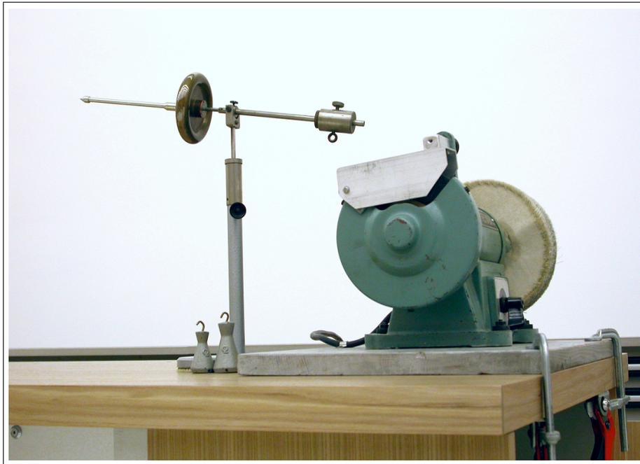
Abbildung 1: Versuchsaufbau kleines Gyroskop
