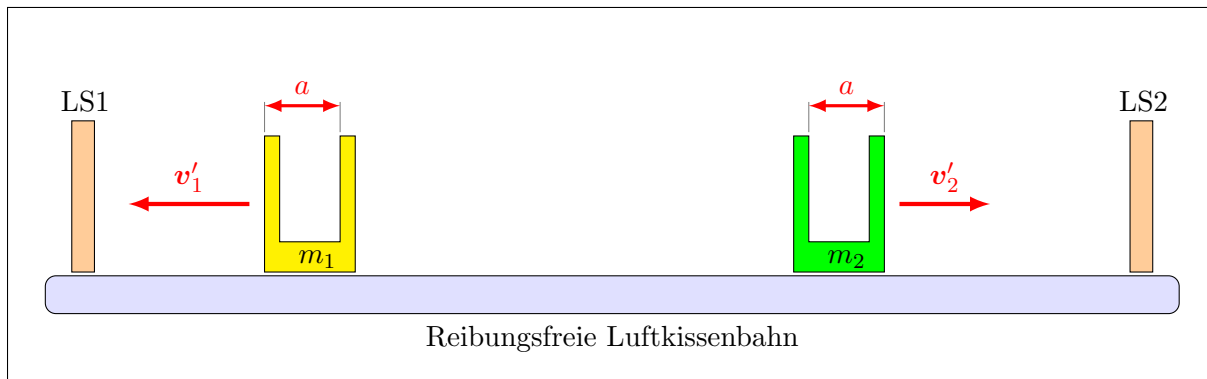
Abbildung 3: Bewegung der beiden Massen m_1 und m_2 nach dem elastischen Stoss. Die Geschwindigkeiten v_1 und v_2 werden mit den Lichtschranken LS1 bzw. LS2 gemessen.
