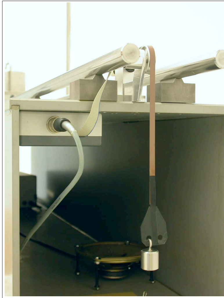
Abbildung 2: Umlenkung der Kraft über ein Laufrad
